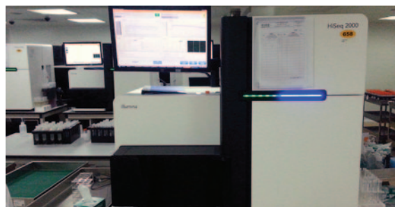
Toate secvențiatoarele de genom pot analiza genoamele, începând de la bacterie și până la organisme mari și complexe. Dispozitivele cu debit sporit de secvențiere a ADN-ului, precum cel al BGI Hong Kong, pot înlocui 50 de dispozitive din generația anterioară, dar și camere pline de echipamente pentru amplificarea E. coli (clonarea și alegerea robotică a coloniilor).
