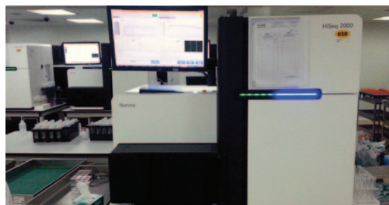
A teljes genomszekvenálók képesek a génállomány elemzésére, a baktériumoktól a nagy, összetett szervezetekig. A nagyteljesítményű DNS-szekvenáló gépek, mint a BGI hongkongi gépei, kiválthatnak az előző generációs gépekből akár ötvenet és az E. coli sokszorozására (klónozás és robotkaros kolóniaválogatás) használt egész szobányi berendezést is.
