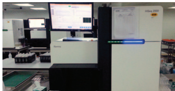
Les séquenceurs de génome complet peuvent analyser les génomes, depuis le génome des bactéries jusqu'à celui des grands organismes complexes. Des séquenceurs d'ADN haut débit semblables à ceux dont dispose le BGI à Hong Kong ont le potentiel de remplacer 50 machines de la précédente génération et des pièces pleines d'équipement pour l'amplification E. coli (clonage et prélèvement de colonies par robot).
